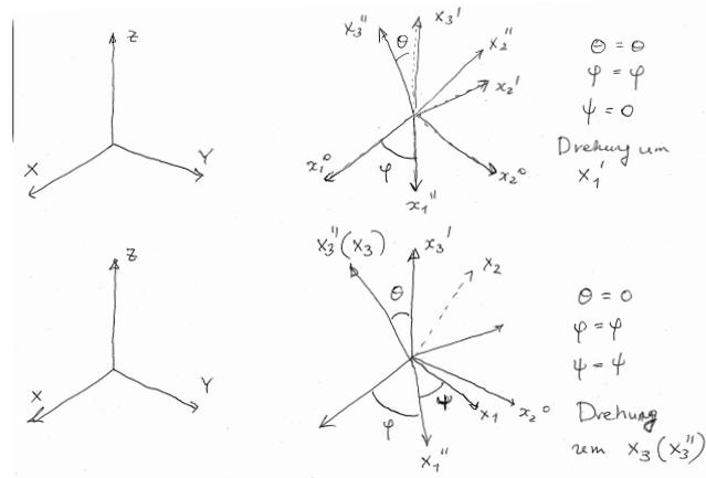
Abbildung 2: Die Reihenfolge der Drehungen.
