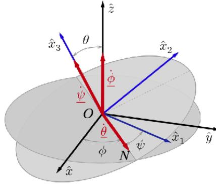
Abbildung 1: Konstruktion der Eulerwinkel.
